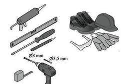
Alati i pribor: (libela; metar; ručna električna bušilica; set burgija za beton; odvrtaći - ravni i zvezdasti; viljuškasti ključevi; čekić; olovka).
